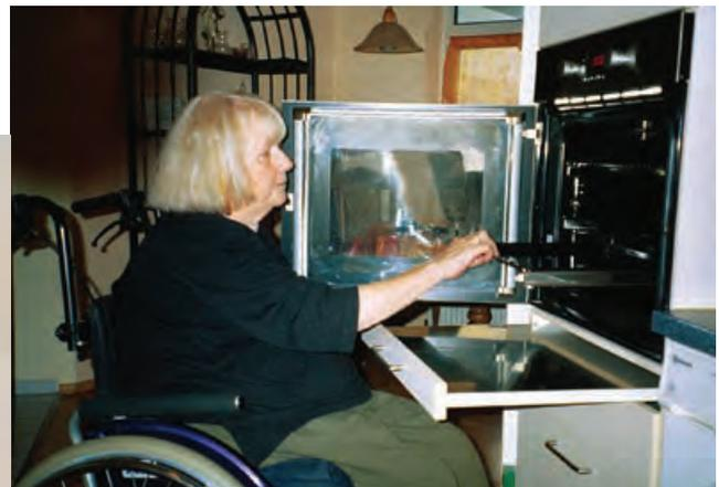
Ausziehbare und unterfahrbare **Arbeitsplatten** unter Herd, Mikrowelle und Backofen schaffen zusätzlichen Platz und Abstellmöglichkeiten und erlauben ein Arbeiten im Sitzen
