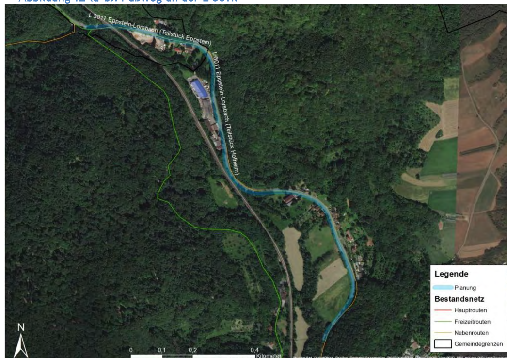
Abbildung 13: Verbreiterung des Fußwegs entlang der L 3011 zwischen Eppstein und Lorsbach
